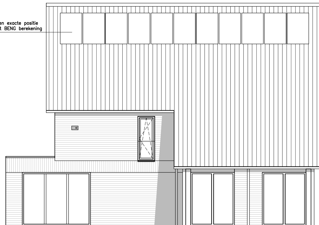
linker zijgevel type D1-P08 / P14 kavel indicatief schaal 1:50
